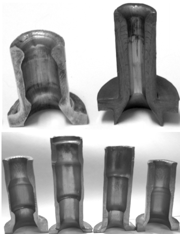
Рис. 8. Детали, полученные радиально-прямым выдавливанием на конусной оправке
